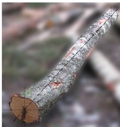
Joonis 8. Liitkõver e mitmesuunalise kõverusega kase nott.
