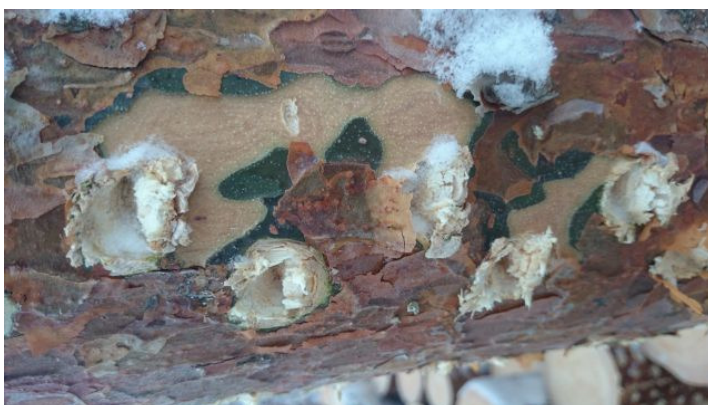
Joonis 21. Järkamislõhed noti otspinnal. Joonis 22. Harvesterirullikute kahjustus
