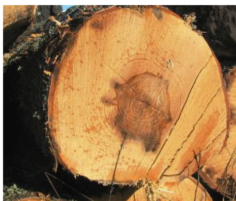
Joonis 21. Järkamislõhed noti otspinnal. Joonis 22. Harvesterirullikute kahjustus
