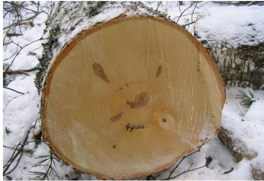
Joonis 17. Radiaallaiksus kasenoti otspinnal.
